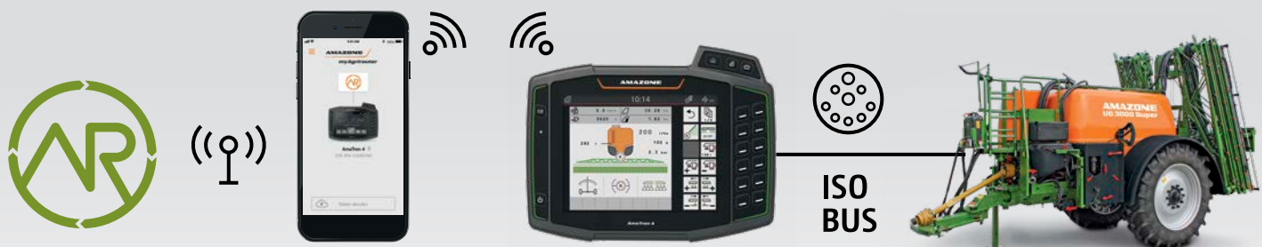
AMAZONE met en œuvre la connexion à la machine ISOBUS via l'AmaTron 4
